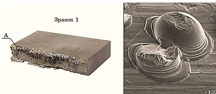
Рис. 3. Зовнішній вигляд зразка 1, що зруйнувався в процесі втомних випробувань.
