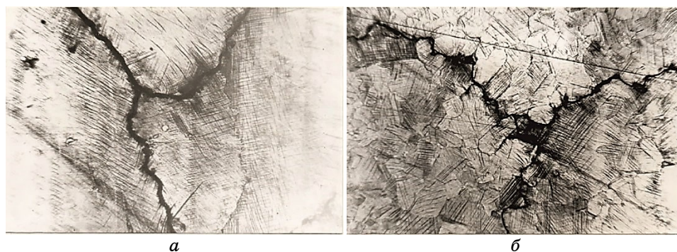
Рис. 3. Зміни в характері поширення тріщин у зруйнованій криці 110Г10Л за різних режимів термічного оброблення: гартування від 1050°C (а), відпал за 600°C + гартування від 980°C (б).
